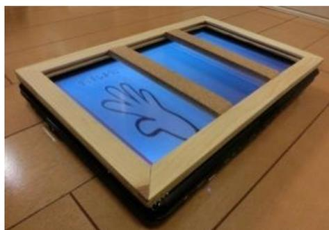
写真1 タブレットPCに木製の補助具を取り付けた様子
