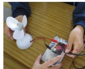
図3 温度で制御する扇風機
