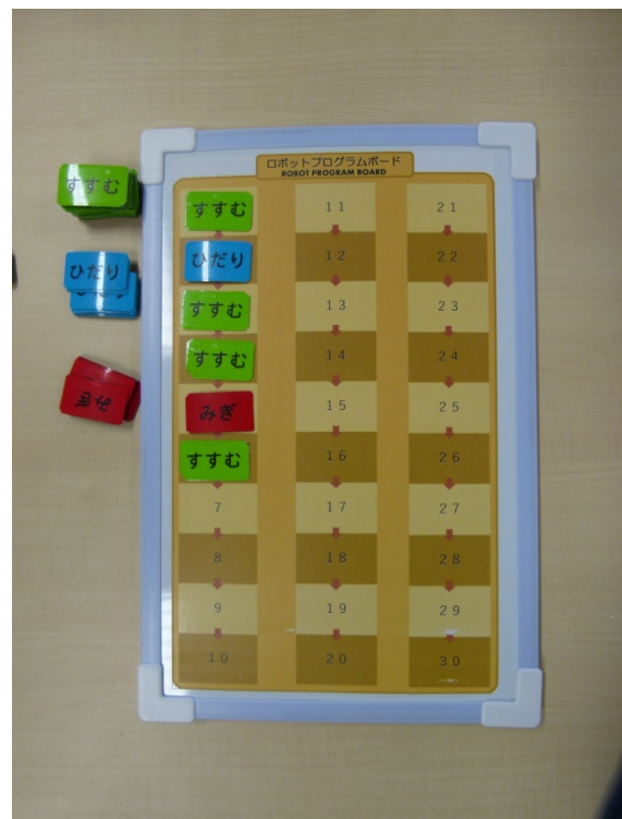
図2 活動1～3で使用するプログラムボードと3種類の命令マグネット
